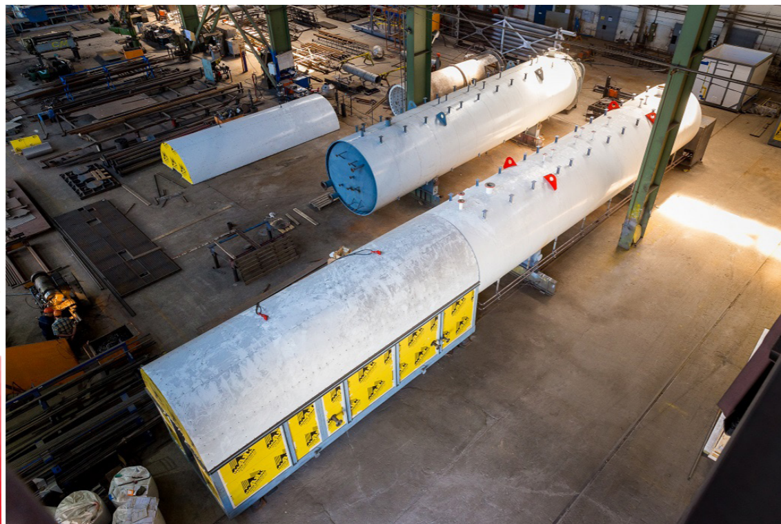
Установка подготовки нефти типа Хитер-Тритер
