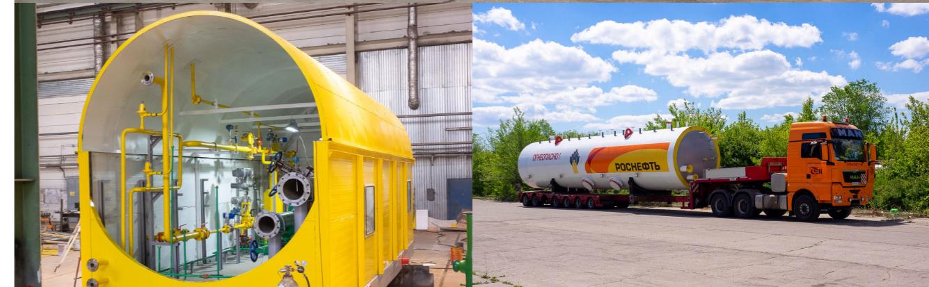
Установка подготовки нефти типа Хитер-Тритер
